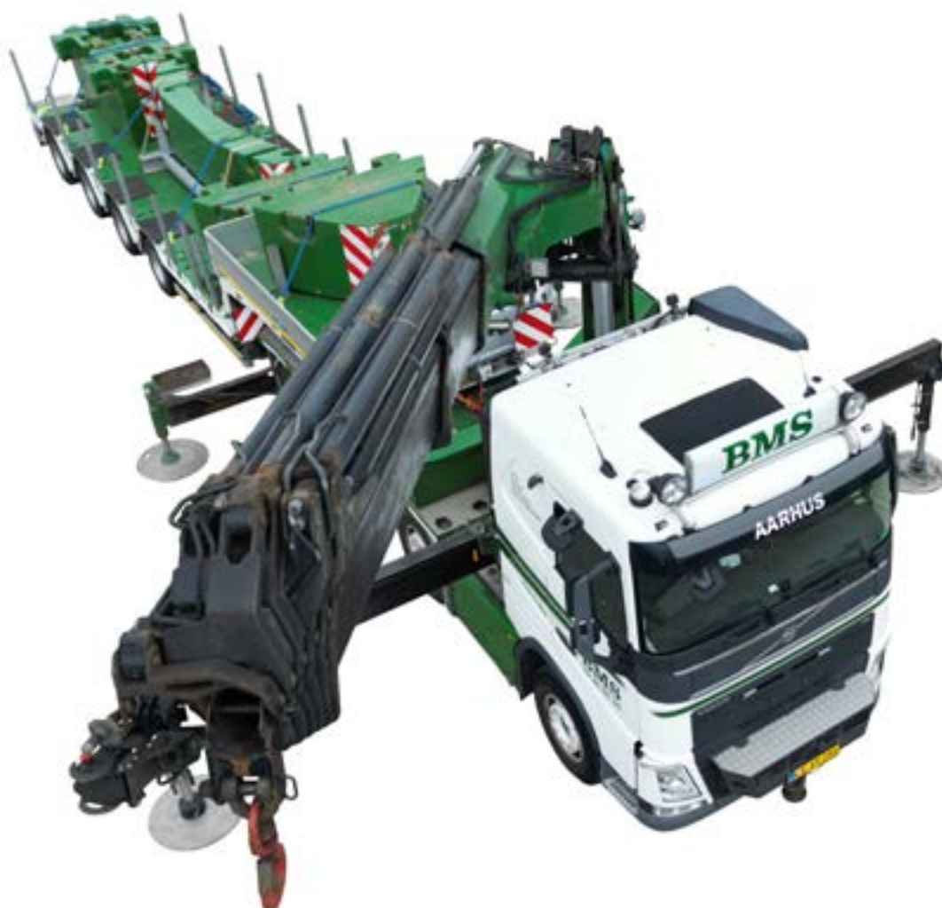
Illustration 6: 50 tonsmeter. lastbilkran er ved at pakke knækarmskranen ud.
