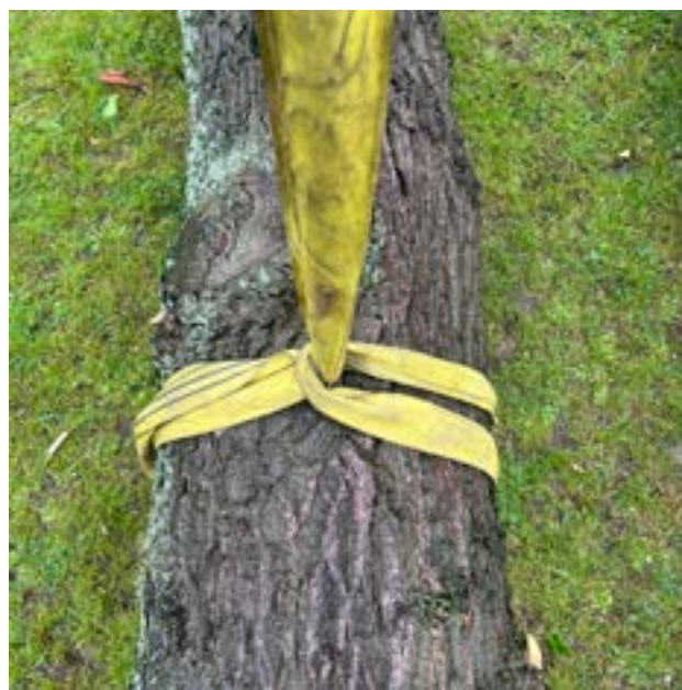
Illustration 9: Sling, WLL = 3 ton, sanset om gren. WLL er her reduceret til 2,4 ton.
