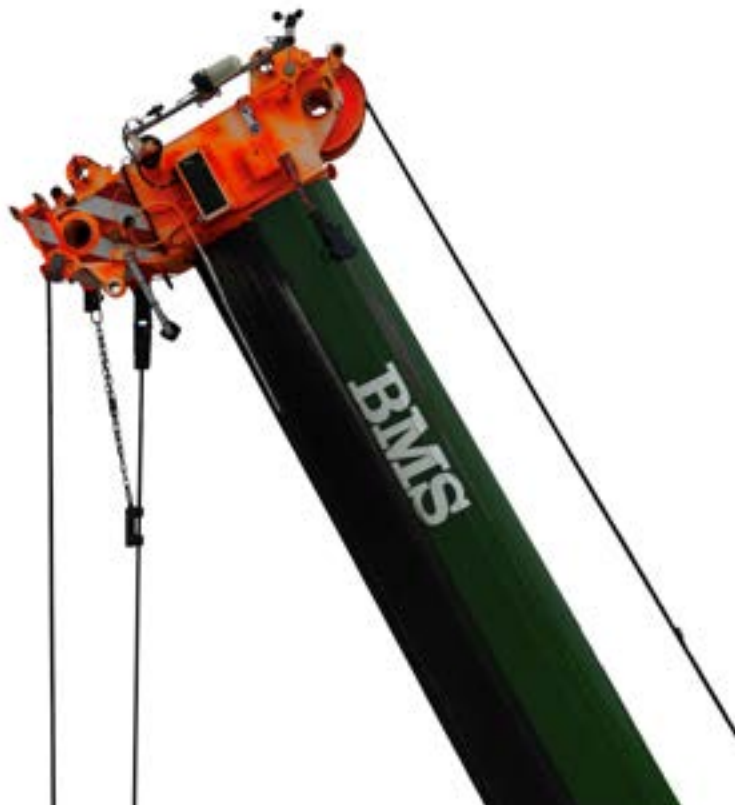
Illustration 4: En vindmåler på toppen af kranen måler den aktuelle vindhastighed.
