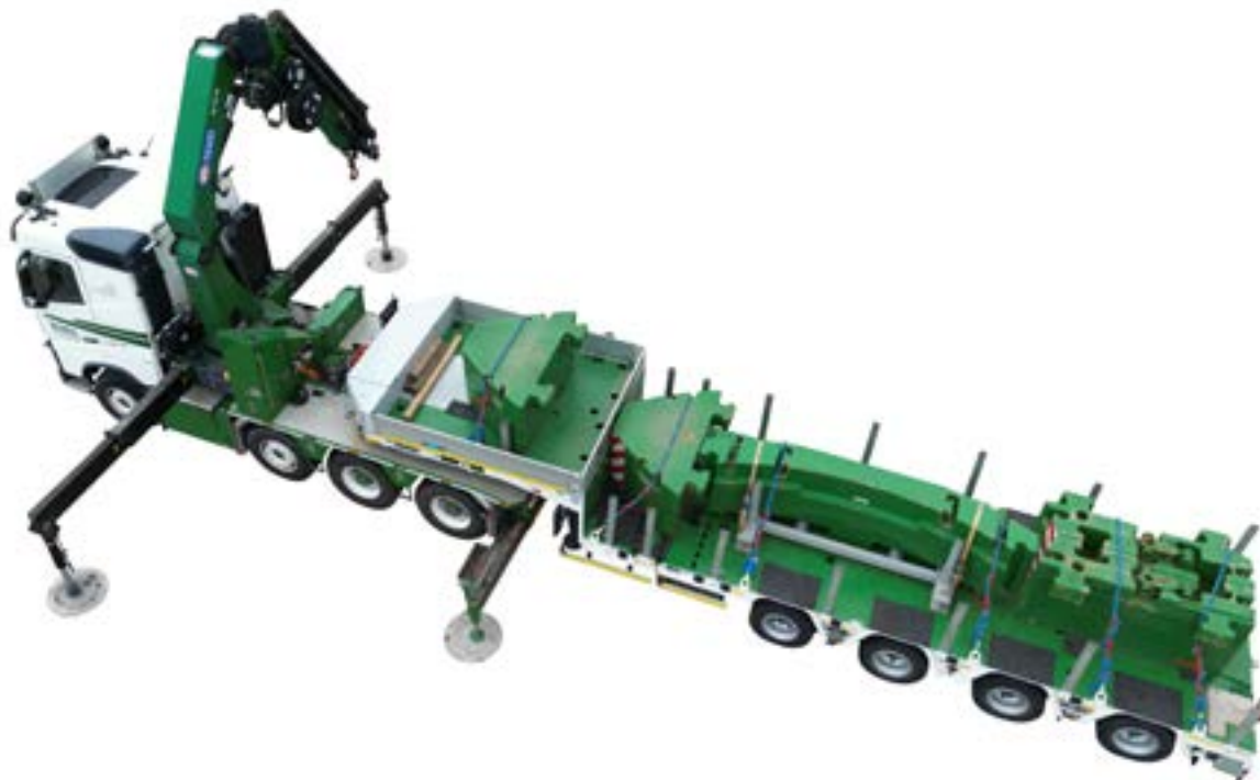
Illustration 5: HMF 5020K Fire-akslet sættevognstrækker med 50 tonsmeter lastbilmonteret kran (knækarmskran). Sættevognen er læsset med ballast.
