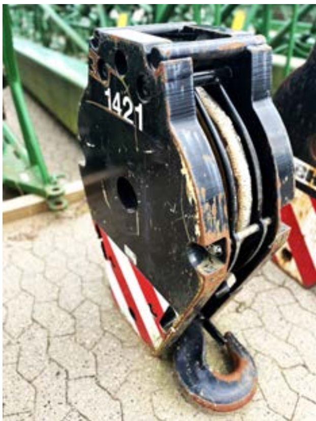
Illustration 16: Krankrog med afhængningssikring, monteret på blok.
