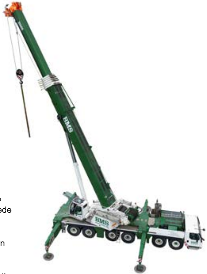
Illustration 11: 300 tons mobilkran før ballast monteres. Liebherr LTM 1300-6.2.
