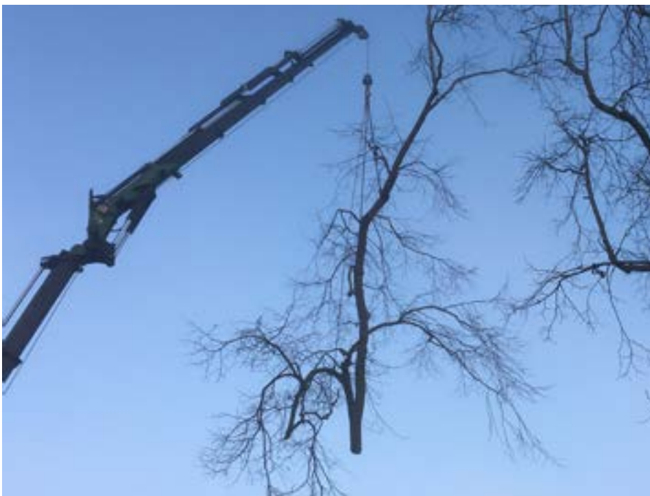
Illustration 4: Ved anhugning af meget tykke sektioner, kan det være en fordel at være to arborister. Denne elmestamme vejer 5 tons.
