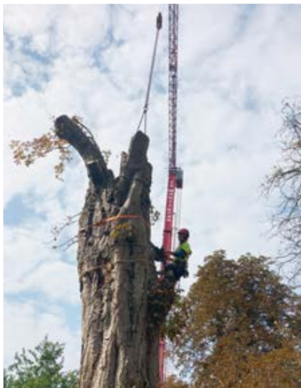
Illustration 20 af Sven Thor Rasmussen: Træfældning med brug af tårmbilkran. Det meget lange vandrette udlæg (op til 60 meter) gør denne krantype ideel i mange situationer, hvor kranen er nødt til at blive stillet op langt fra træet.
