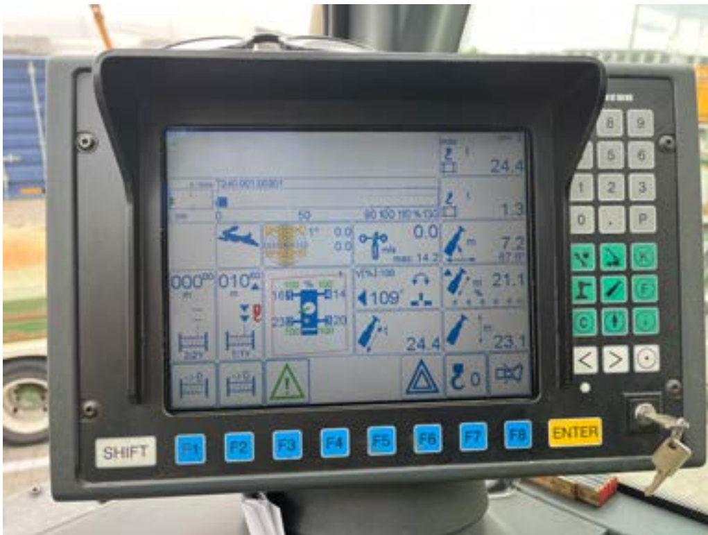
Illustration 12: Kranførerens skærm. Her kan blandt andet, meget nøjagtigt, aflæses løfteevne og aktuell belastning af kranen.
