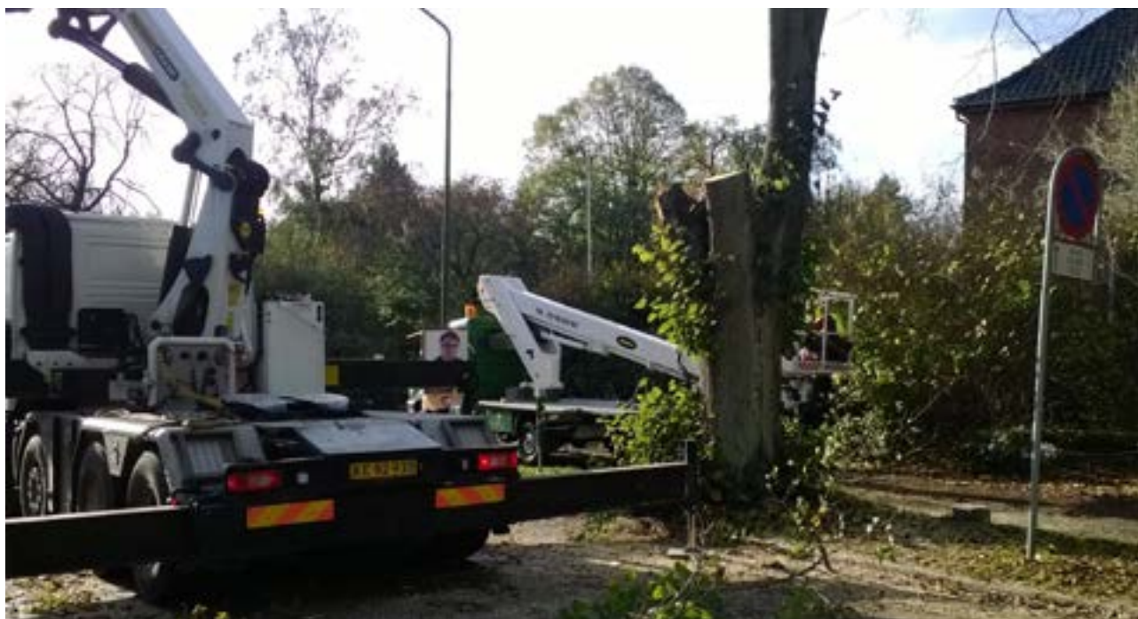
Illustration 3: Dropzone (hvor de anhuggede sektioner landes og afhugges), er væk fra lastbilliftens støtteben.
