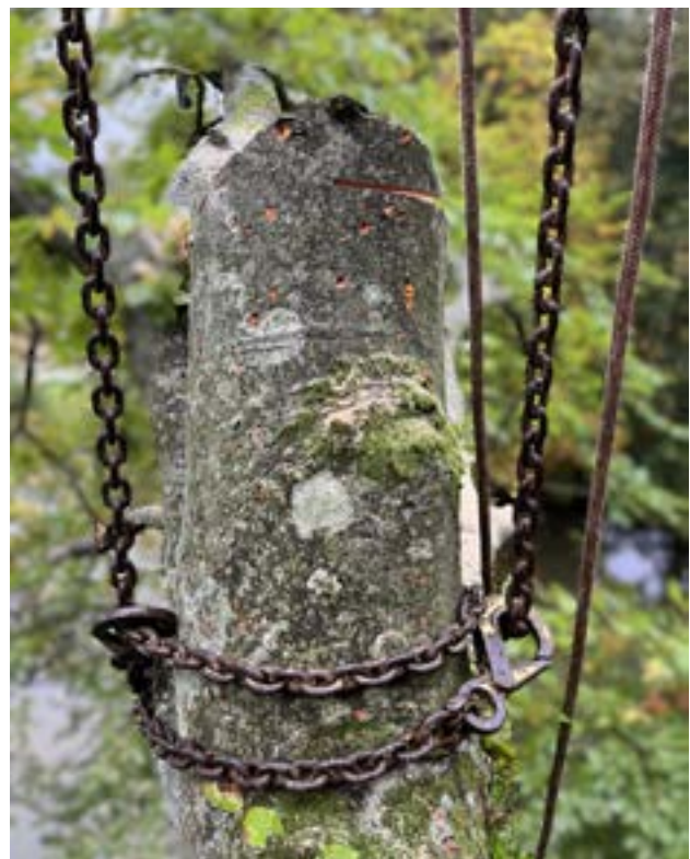
Illustration 14: Detalje af anhugning med to kæder modsat på lodret stammedel. Bemærk krogenes placering.
