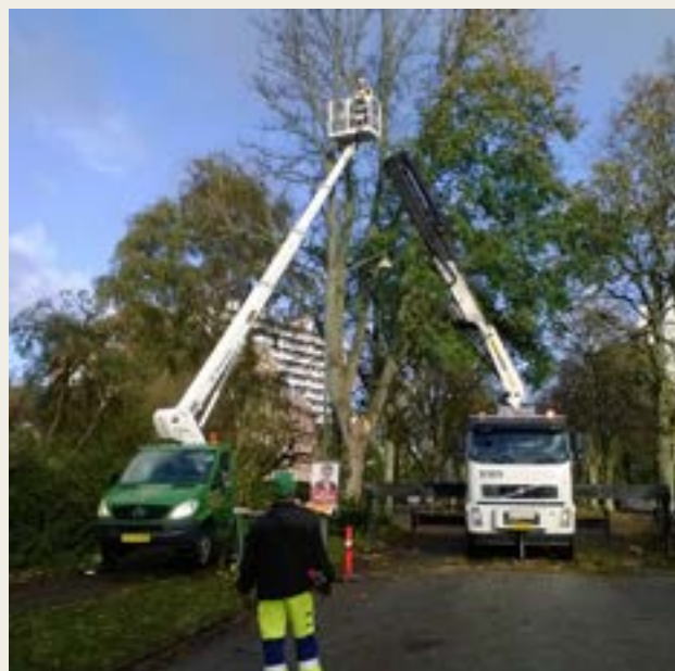
Illustration 1: Arboristen arbejder fra 22 meter lastbillift. Lift og kran kan arbejde frit af hinanden. Træet her var, i en storm, delvist kollapsede og havde ramt to parkerede biler.
