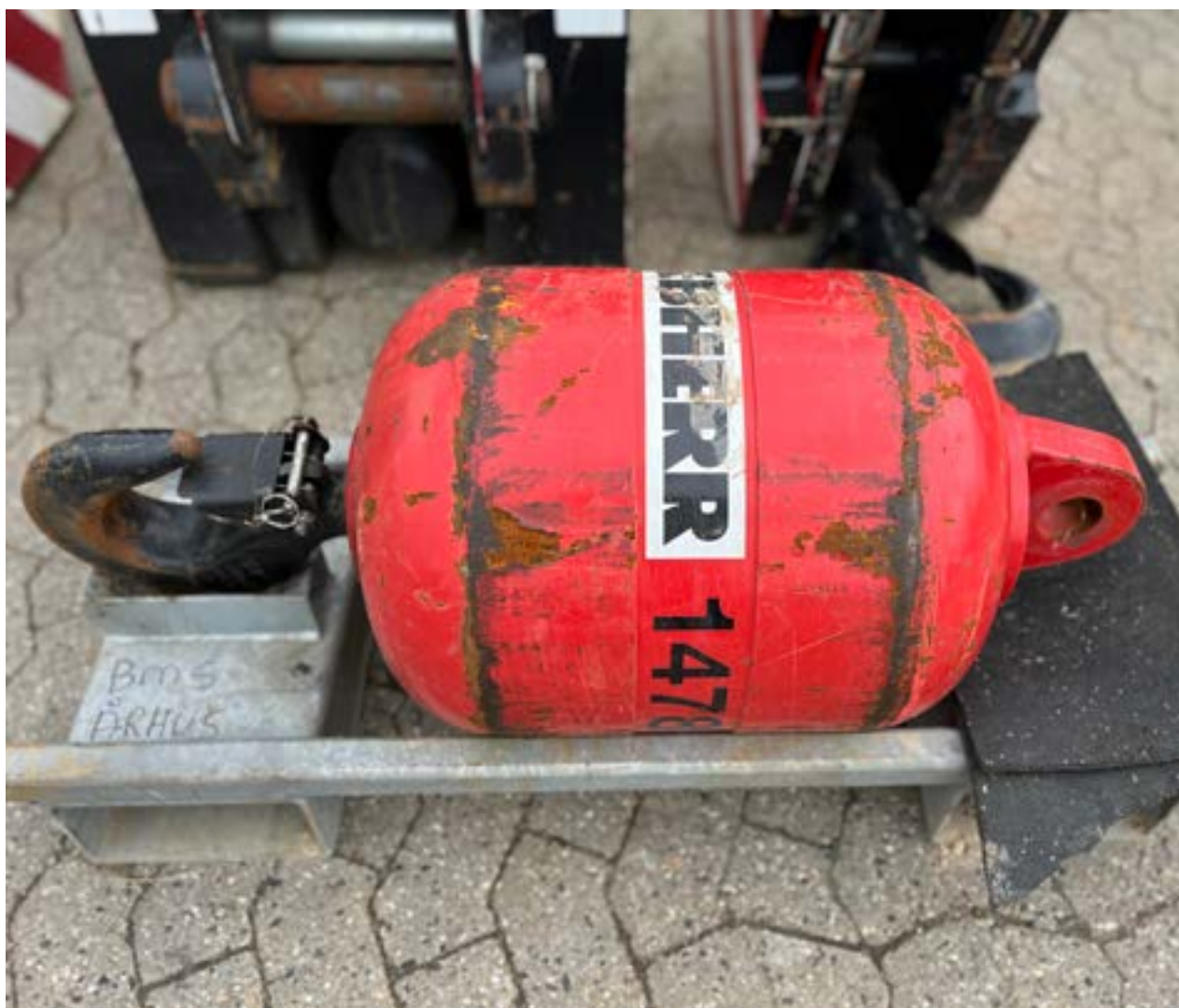
Illustration 15: WLL 12,2 tons, ingen ruller, 1 skæring, krogens vægt 500 kg.
