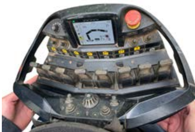
Illustration 10: Fjernbetjening til lastbilkran. Den aktuelle belastning kan aflæses i % på displayet. Tallet til venstre er hovedarm og til højre jib. For at kende den aktuelle løftekapacitet, tælles antal udskud og der aflæses på krandidiagram, der er monteret på kranen.
