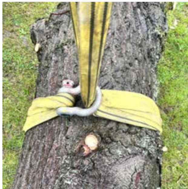
Illustration 8: Sling, WLL = 3 ton, sanset om gren med brug af sjækel. WLL er her reduceret til 2,4 ton. Den glidende del af stroppen går gennem buen, så man undgår at bolten skruer sig løs ved opstramning.
