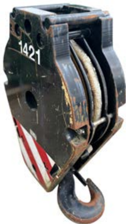
Illustration 16: WLL 36,2 tons, 1 rulle, 3 skæringer af wire, krogens vægt 1.000 kg.
