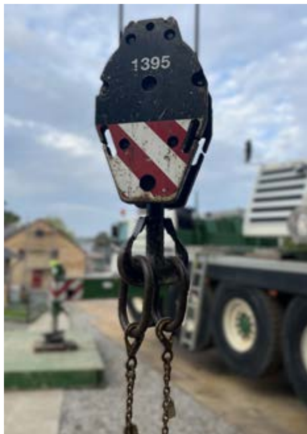
Illustration 17: Kranblok med to kroge, monteret med to enkeltkæder.
