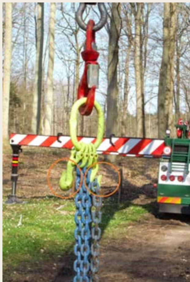
Illustration 6: Kroege til opkortning af kæde.
