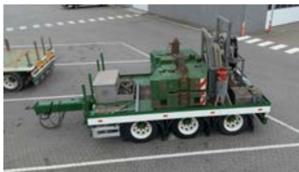
Illustration 4: Kærre til mobilkran. Her er bl.a. ballast, løftegrej, støttebensplader og krankroge.
