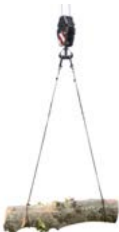
Illustration 7: Balanceret løft med to sansede kæder. WLL er her reduceret til 80 % af oprindelig godkendelse.
