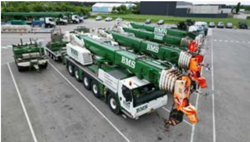
Illustration 1: Mobilkraner i forskellige størrelser. Påhængskøretøj er lastet med ballast, støttebensplader, løftegrej, forskellige løftekroge og andet. I baggrunden ses to lastbilkraner.
