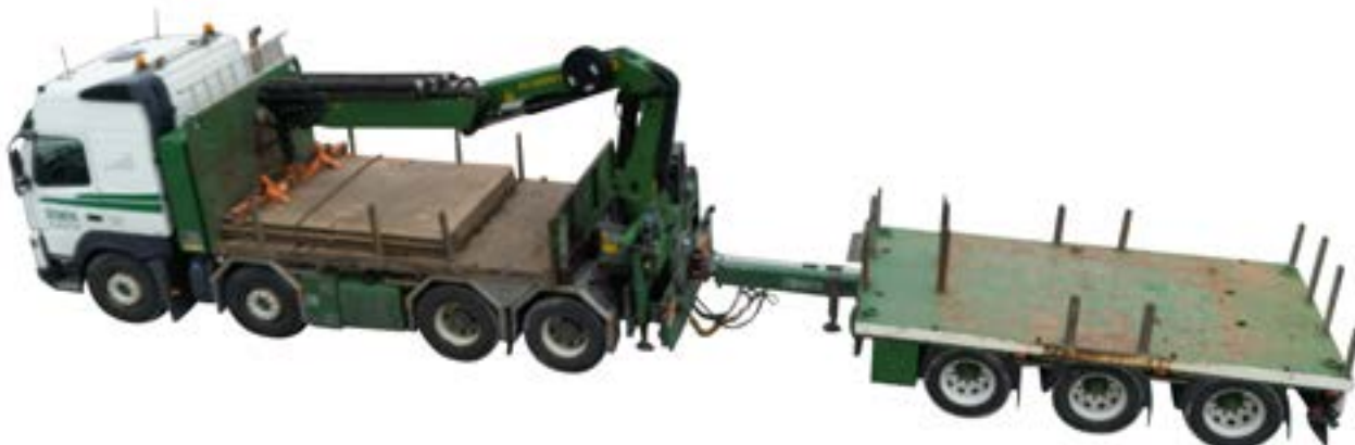
Illustration 7: 5-07. Pladebil med pladeåg monteret i kranen til hurtig og præcis udlægning af jernkøreplader.
