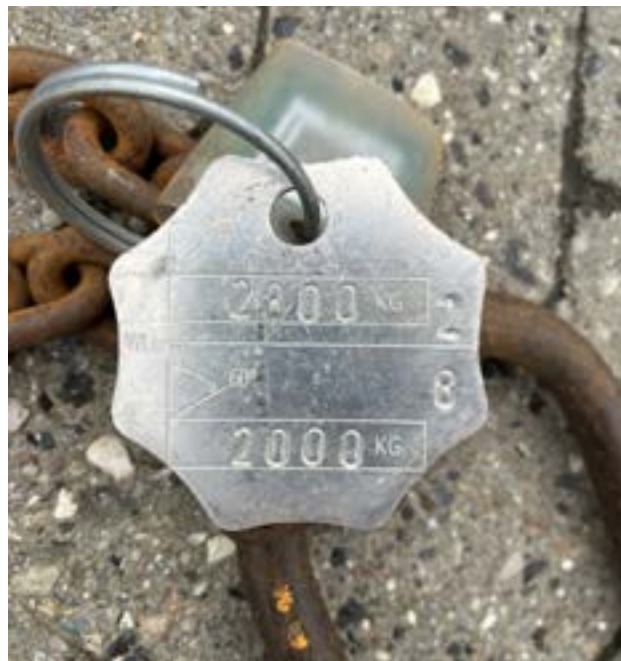
Illustration 7: Godkendelsesskilt med angivelse af WLL.
