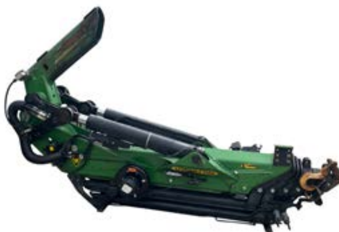
Illustration 7: Aftagelig jib. Jib'en giver en længere rækkevidde, men reducerer den maksimale løftekapacitet, da den er svagere end hovedarmen. I dette tilfælde er den maksimale løftekapacitet 2.240 kg.
