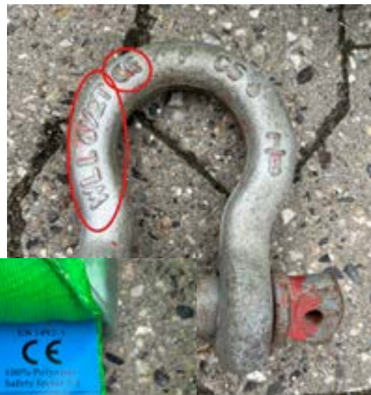
Illustration 10: Sjækel med WLL- og CE-mærkning.
