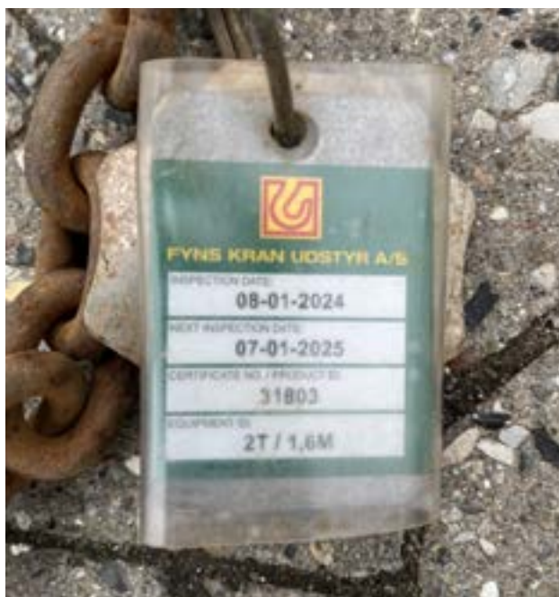
Illustration 4: Kontrolmærke for årligt eftersyn af kæde.
